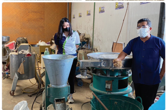
อุปกรณ์ในการผลิตและส่วนผสมในการผลิตฟางข้าวอัดเม็ด
