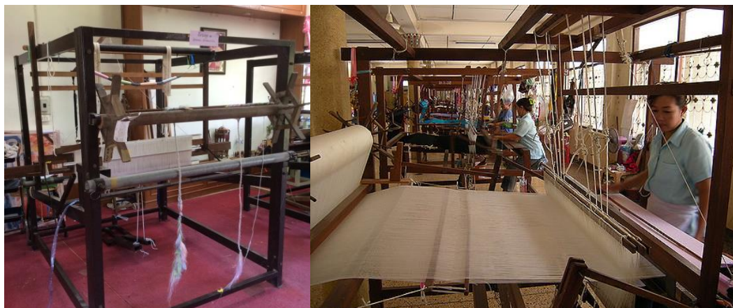
ภาพ 9 การทอผ้าด้วยกี่กระตุก ที่มา : (ดารุณี ทับทอง, 2553, หน้า 20)
