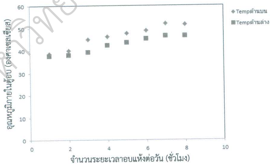
รูปที่ 4.3 อุณหภูมิภายในตู้อบ ติดตั้งแผ่นสะท้อน30°
