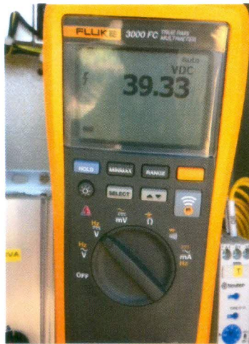
รูปที่ 4.6 แสดงการวัดแรงดันขณะเครื่องสูบน้ำทำงานโดยใช้พลังงาน ( โซล่าเซลล์ )
