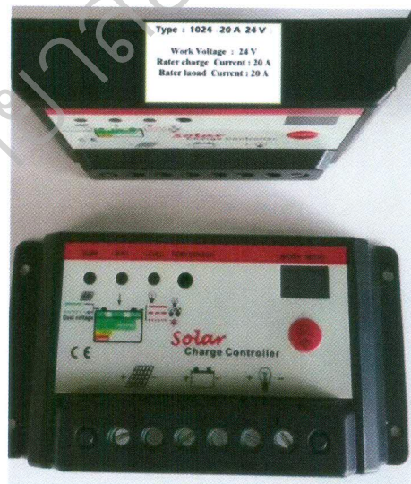
รูปที่ 3.11 ชาร์จคอลลโทรลเลอร์ 24V / 20 A ที่กลุ่มผู้วิจัยเลือกใช้ใช้งาน
