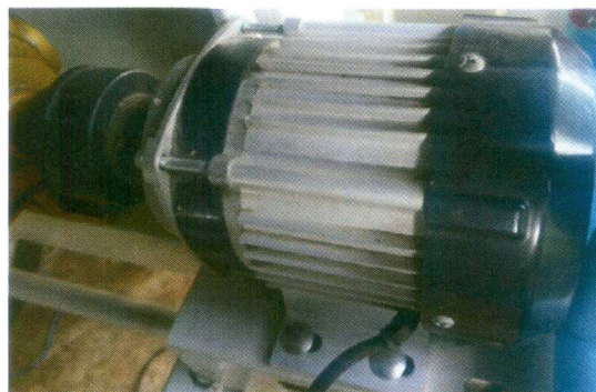
รูปที่ 3.7 BLDC มอเตอร์ ที่ใช้งานของผู้วิจัย
