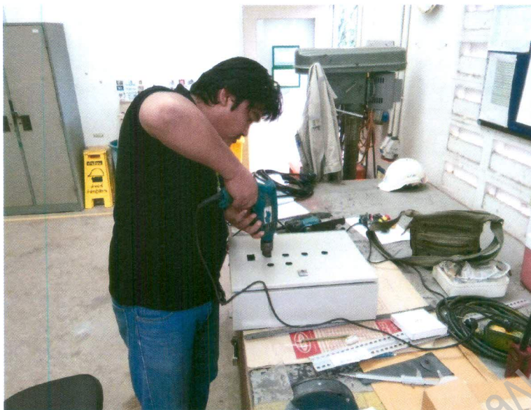
รูปที่ ข.2.2.9 เจาะรูใส่อุปกรณ์ไฟฟ้าชุดคอนโทรลหลัก
