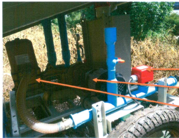
รูปที่ ค.2.6 ส่วนประกอบของเครื่องสูบน้ำพลังงานแสงอาทิตย์
