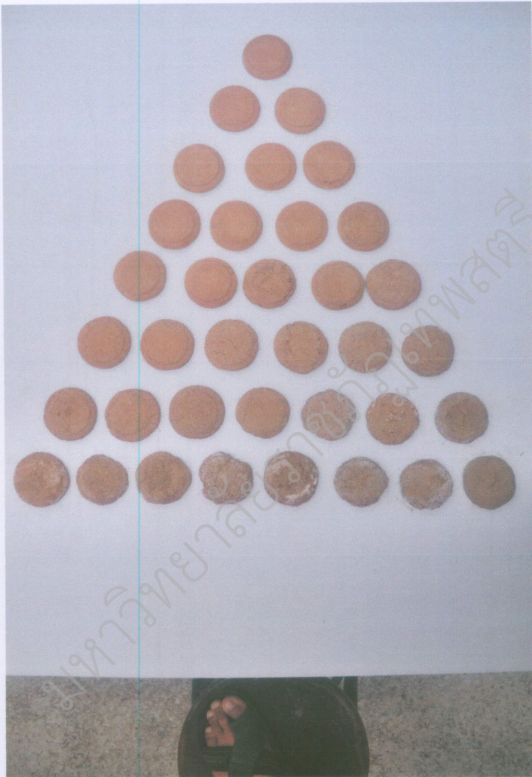
ภาพที่ 19 รันทดสอบที่ผ่านการเผาที่อุณหภูมิ 1,000 องศาเซลเซียส เป็นเวลา 10 ชั่วโมง
