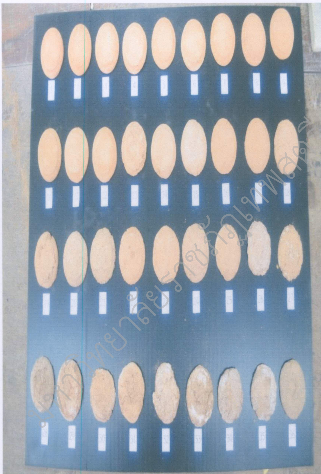
ภาพที่ 7 ชั้นทดสอบที่ได้ หลังนำมาทดสอบการต้านทานการเปลี่ยนแปลงอุณหภูมิโดยเฉียบพลัน ที่อุณหภูมิ 300 องศาเซลเซียส (ทดสอบ 3 ชั่วโมง)
