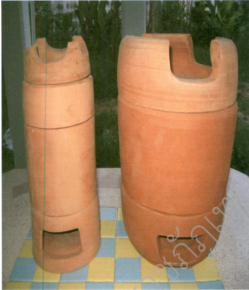
ภาพที่ 10 เตาดินเผาชีวมวลขนาดเล็ก(ซ้าย) และเตาดินเผาชีวมวลขนาดใหญ่ (ขวา)
