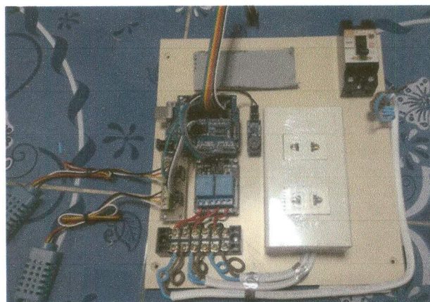
รูปที่ 3.7 ประกอบอุปกรณ์ตามแบบบนแผ่นอะคริลิกของตู้ควบคุม
