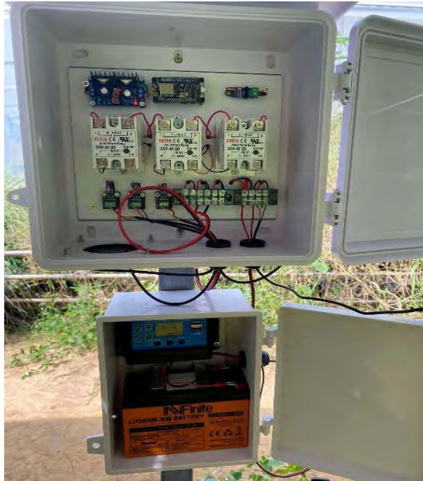
ภาพที่ 7.4 ชุดควบคุมอุณหภูมิและเชื่อมต่ออุปกรณ์ของระบบควบคุม ที่มา: ธีรภัทร แสงไชย และศักดิ์ชัย อินจู (2568)
