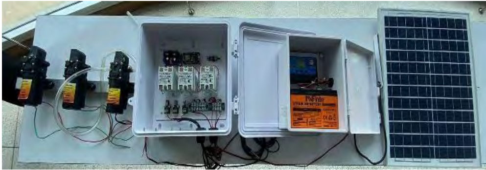
ภาพที่ 7.5 ชุดควบคุมอุณหภูมิโดยใช้โซลิดสเตตรีเลย์ (Solid state Relay)
