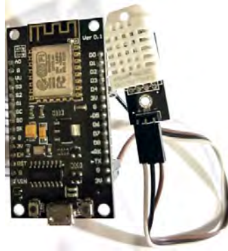
ภาพที่ 6.15 NodeMCU ESP8266 V3 เชื่อมต่อกับ DHT22 ที่มา: ศักดิ์ชัย อินจู (2568)
