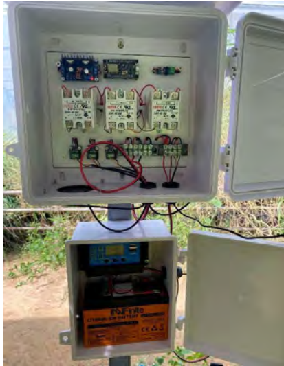
ภาพที่ 1.11 ชุดควบคุมอุณหภูมิและเชื่อมต่ออุปกรณ์ของระบบควบคุม ที่มา: ธีรภัทร แสงไชย และศักดิ์ชัย อินจู (2568)
