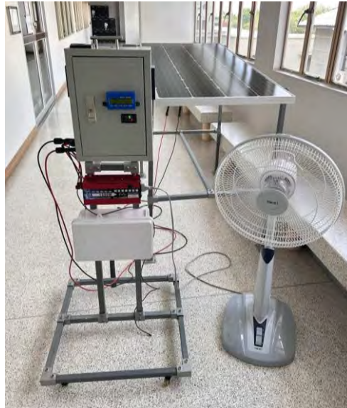
ภาพที่ 5.2 ชุดพลังงานโซลาร์เซลล์ขนาดเล็ก ที่มา: ศักดิ์ชัย อินจู (2568)
