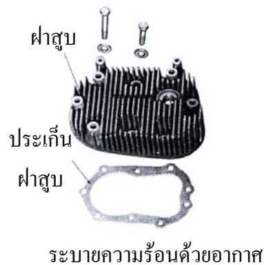
รูปที่ 2.12 ฝาสูบแบบต่าง ๆ ที่นิยมใช้กับเครื่องยนต์เล็ก ทีมา (ประณต กุลประสูตร, 2538, หน้า 24)
