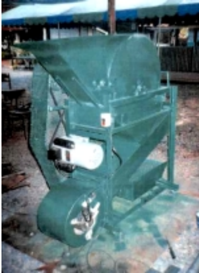
เครื่องกะเทาะเปลือกถั่วลิสงแบบ ล้อยางรถยนต์
