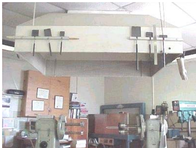
รูป 4.1 ระบบดูดก๊าซ (Hood) อยู่เหนือตะเกียงเป่าแก้ว
